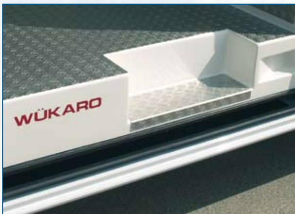
Vertiefung für Türhaltebänder mit Stoßschutz aus Edelstahl und Druckentlüftung für Laderaum.*
